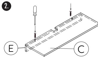
Con los tornillos drywall 6x1 1/4" atornille la Tapa (C) al zócalo a muro (E).
