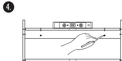
Mida y marque la altura donde va a quedar instalada la repisa, la medida se toma desde el piso hasta la altura deseada, le recomendamos usar un nivelador para que quede derecha.
