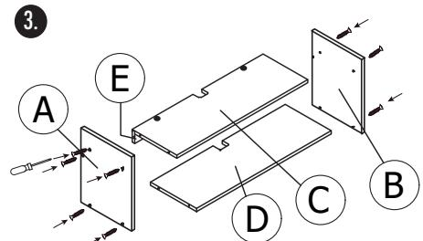
Ensamble la Tapa (C), la Base (D) y el zócalo a Muro (E) a los 2 laterales (A y B) con los tornillos drywall 6x1 1/4".
