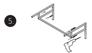
Proceda a anclar los soportes a la pared con los tornillos drywall 10x2".
