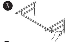
Mida y marque la altura del soporte donde va a quedar instalada la repisa, la medida se toma desde el piso hasta la altura deseada.
