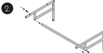
Ensamble los soportes a los travesaños con los tornillos bristol cabeza de botón 1/4 X1".
